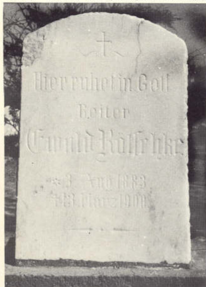
Plate XVIII.—“Sugaring” of 60-year old tombstone at Swakopmund cemetery; white Italian marble. (Photo: P. O. Petzold.) Plaat XVIII.—“Versuikering” van ’n 60-jaar-oue grafsteen in die Swakopmundbegravingplaas; wit Italiaanse marmer. (Foto: P. O. Petzold.)
