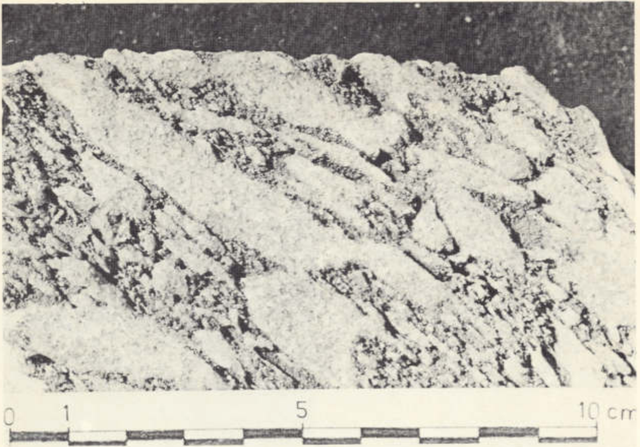
Plate XI.—Weathered surface of flamed marble consisting of white fragments in white matrix (loc. 31, fold. 1). Plaat XI.—Verweerde oppervlak van gevlamde marmor wat uit wit brokstukke in 'n wit grondmassa bestaan (lok. 31, voubl. 1).
