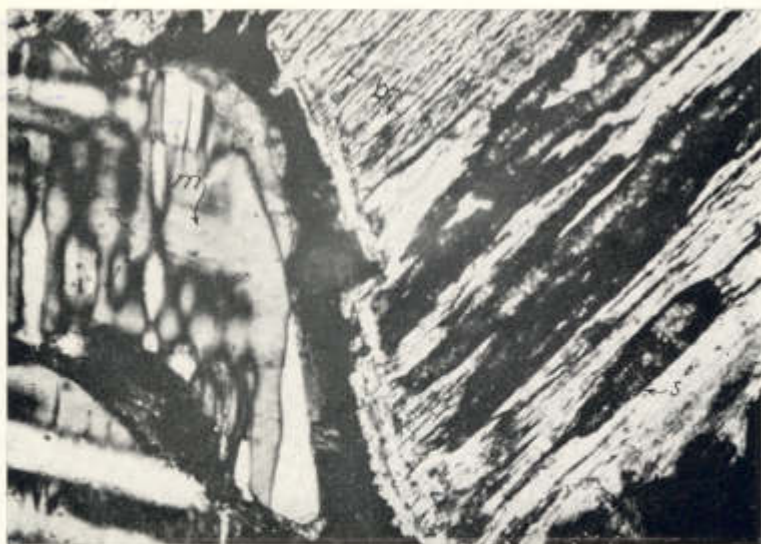
PLATE VII.—Anhedronal sphene (s) situated in and parallel to the basal cleavage of biotite (b). (Sample SM 71.) m—microcline. Crossed nicols, \times 100 . PLAAT VII.—Onievormige sfeen (s) in en ewewydig aan die basale splyting van biotiet (b). (Monster SM 71.) m—mikroklien. Gekruiste nicols, \times 100 .
