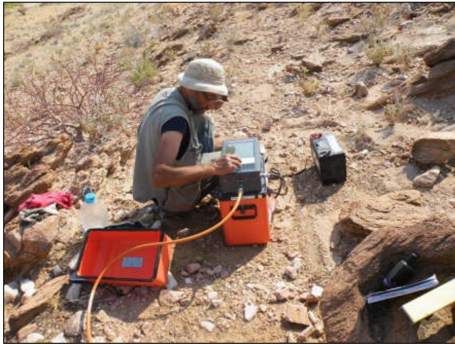
Fig. 4. Data acquisition with Stratagem EH4 EM (MT) system.
